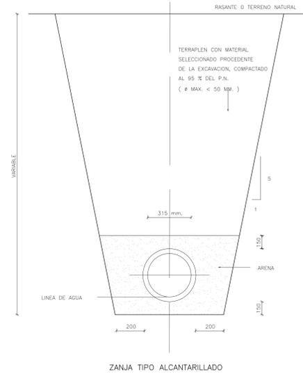
ZANJA TIPO ALCANTARILLADO
